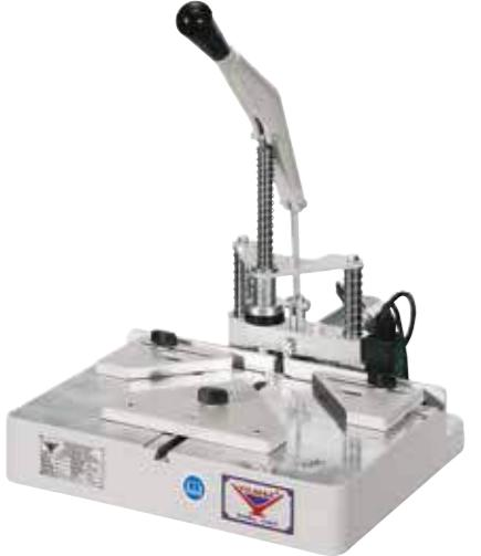
Ahşap profillerin köşe birleştirme kanallarını acar.
